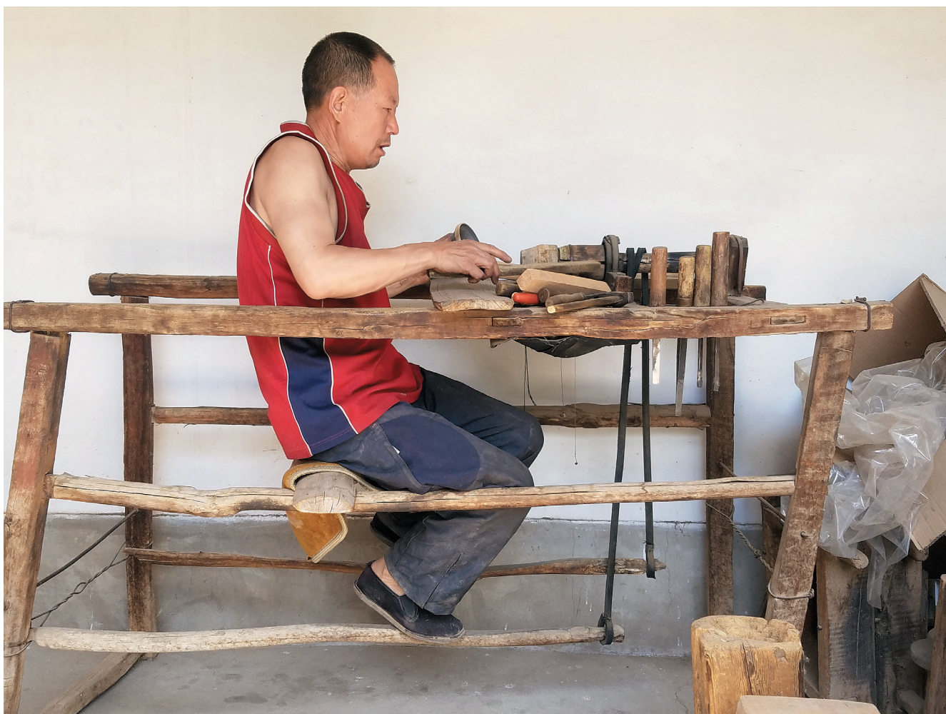
“王氏铸铜技艺”的王成德使用木车打磨抛光金刚铃
